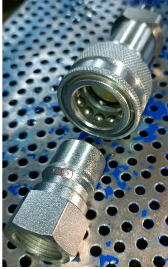
Şekil 3.2. 650 bar basınç altında test edilmiş hasara uğramamış bilyeli bağlantı elemanı.[url-1]
