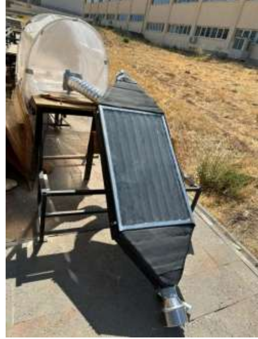
Şekil 1. Havalı güneş kolektörünün 3D geometrisi ve deneysel düzenek
