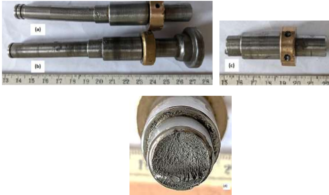
Şekil 1. a) Hasarlı-Bükülmüş, b) Hasarsız, c) Hasarlı-Kırık ve d) Kırık yüzey morfolojisi.
