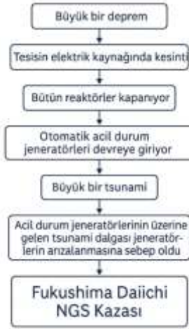
Şekil 40 - Fukushima Nükleer Santrali Kazası oluşum mekanizması
