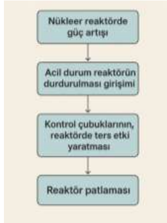
Şekil 39- Çernobil Nükleer Santrali Kazası oluşum mekanizması
