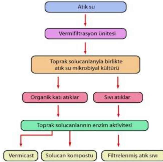
Şekil 5. Solucanların enzim aktivitesi kullanılarak atık su arıtımına ilişkin akış şeması.
