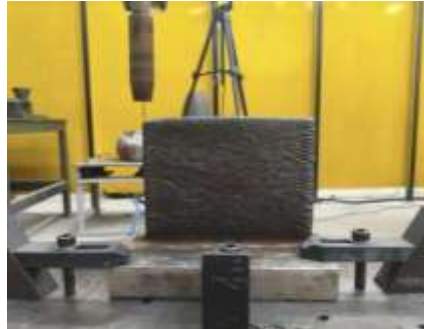
Şekil 2. WAAM yöntemi ile üretilen numunenin genel görünümü
