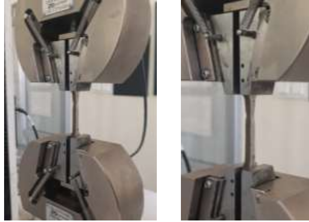
Şekil 7. Çekme testi sırasında numunenin boyun verme davranışı
