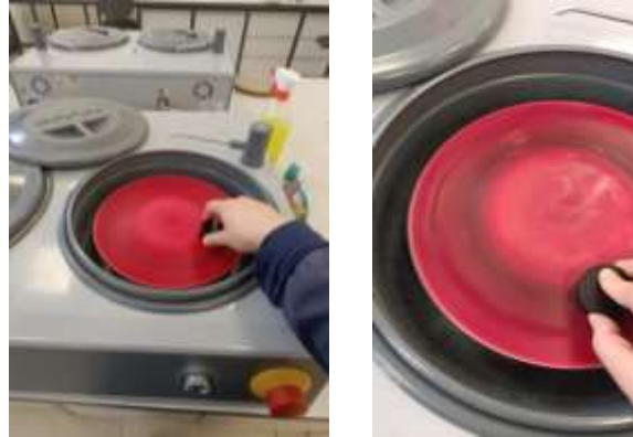
Şekil 5. Mikroyapı numunesinin ön parlatma aşaması
