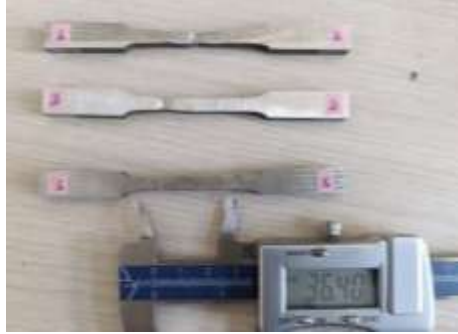
Şekil 8. Çekme testi sonrası kopmuş numunelerin görünümü
