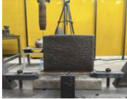
Şekil 2. WAAM yöntemi ile üretilen numunenin genel görünümü
