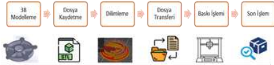
Şekil 1.WAAM üretim sürecinin adımları
