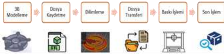
Şekil 1. WAAM üretim sürecinin adımları
