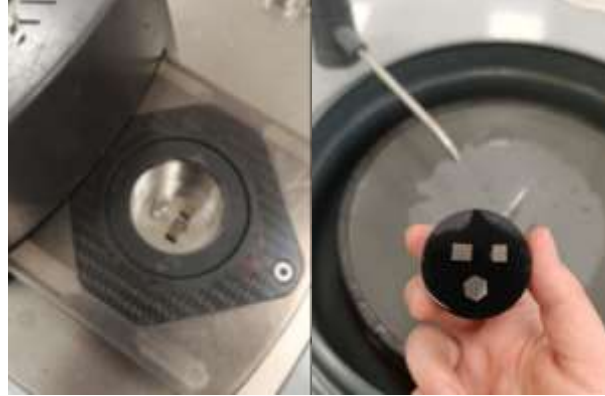
Şekil 4. Bakalite alınıp diğer işlemlere hazırlık süreci
