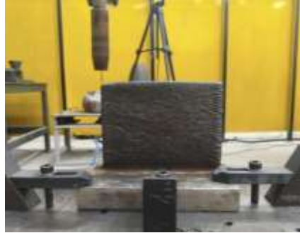
Şekil 2. WAAM yöntemi ile üretilen numunenin genel görünümü
