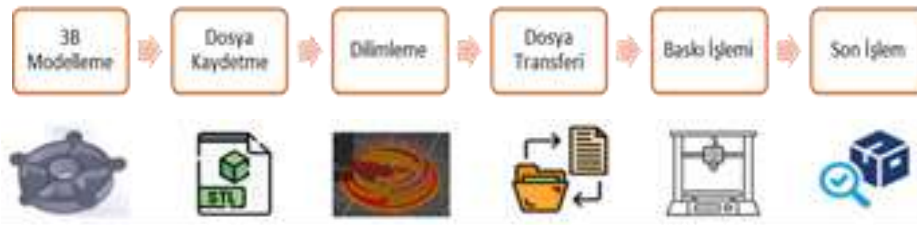
Şekil 1. WAAM üretim sürecinin adımları
