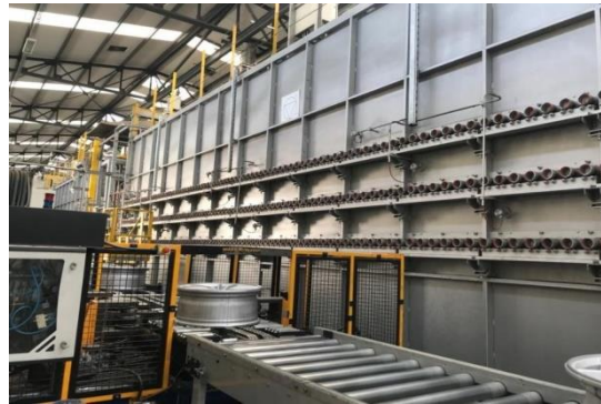
Şekil 5. Ürünlere uygulanan çökelme sertleşmesi ısıl işlem hattı
