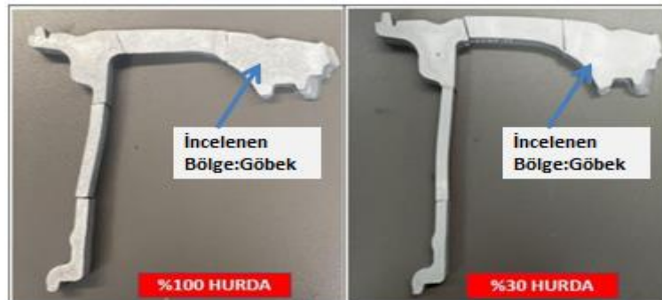
Şekil 7. %30 ve %100 hurda AlSi7Mg alaşımı ile üretilen jantların kesit görüntüsü
