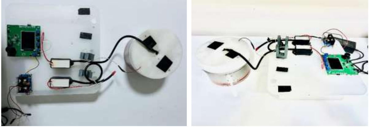
Şekil 1. Jelatin hidrolizi için kullanılan vurgulu elektrik alan sistemi
