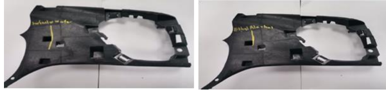
Şekil 5. İç trim estetik parça braket temizlik ürünlerine karşı direnç testi uygulaması
