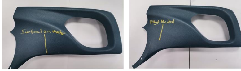
Şekil 4. İç trim estetik parça temizlik ürünlerine karşı direnç testi uygulaması
