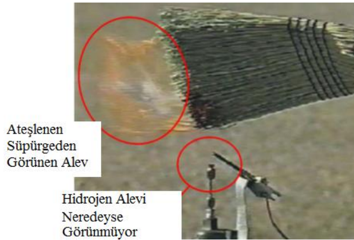
Şekil 2.3. Atmosferik koşullarda yanmakta olan hidrojen alevi
