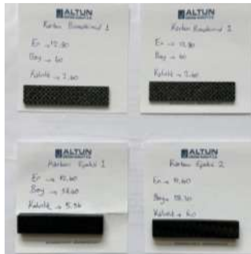
Şekil 5. Eğilme test numuneleri ve üç nokta eğilme test anı.
