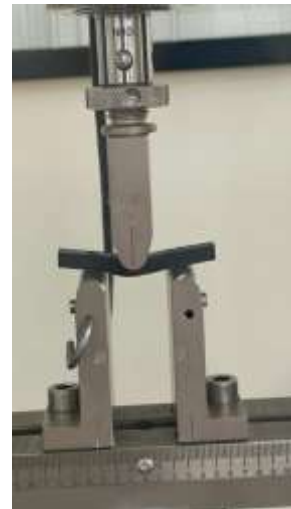
Şekil 5. Eğilme test numuneleri ve üç nokta eğilme test anı.
