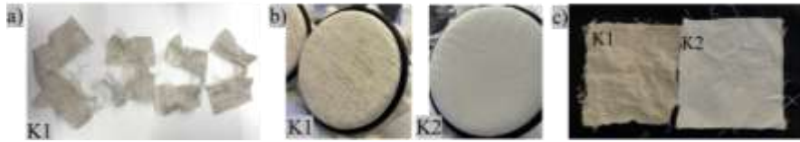
Şek 4. a) Kenevir kumaşın yırtılma mukavemeti ilk deney sonucu b) Boncuklanma direnci test sonucu c) Buruşma dayanımı testi sonucu
