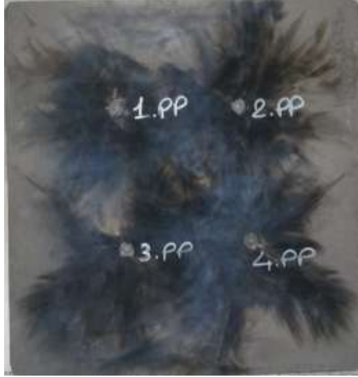
Şekil 6. Balistik Test Sonrası 500 HB Malzeme
