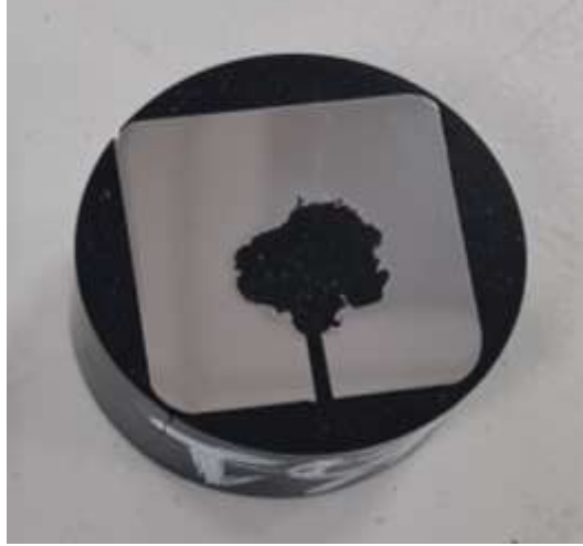
Şekil 7. Balistik test sonrası bakalite alınmış 500 HB numune
