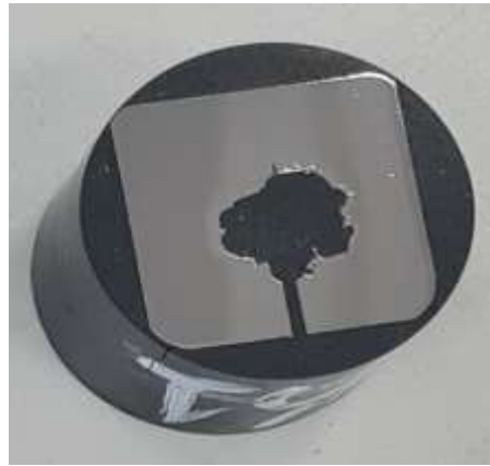
Şekil 4. Balistik test sonrası bakalite alınan 600 HB malzeme
