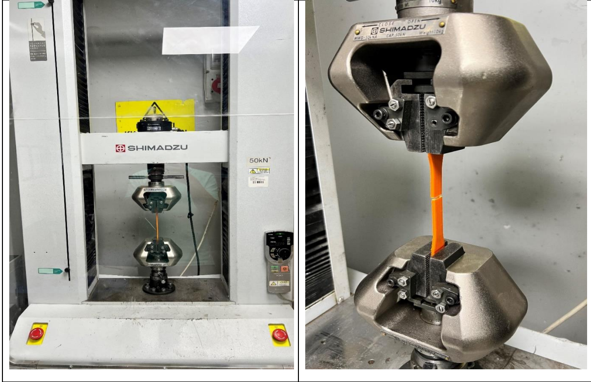
Şekil 6. Shimadzu çekme test cihazı ve kopma anından birer görünüş.
