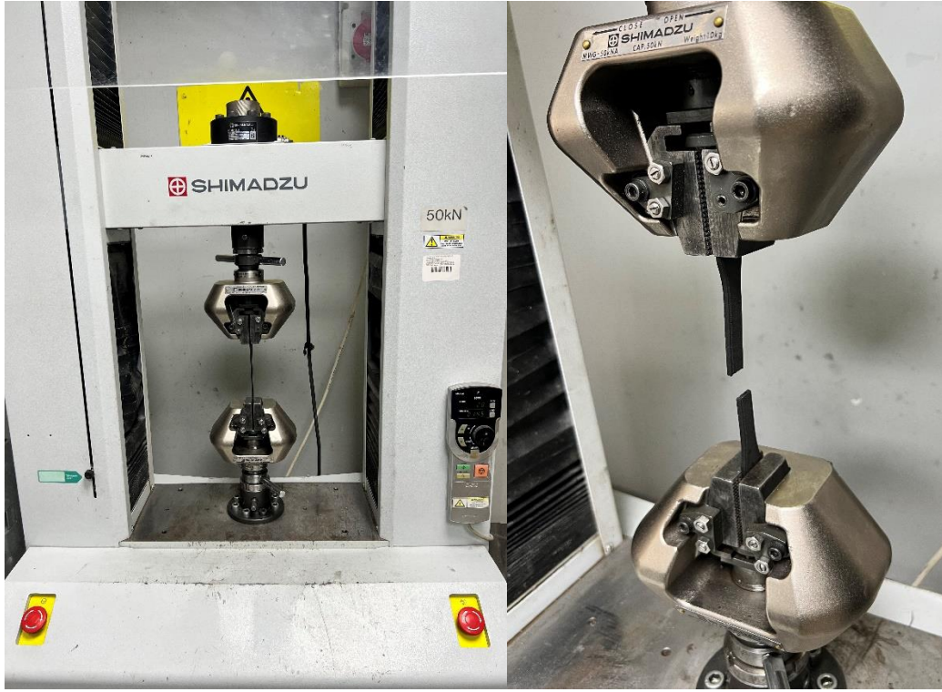
Şekil 5. Shimadzu çekme test cihazı ve kopma anından birer görünüş.
