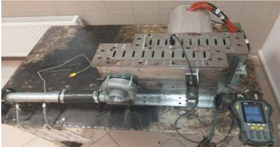
Şekil 1. Titreşim Ölçümü Test Düzeneği
