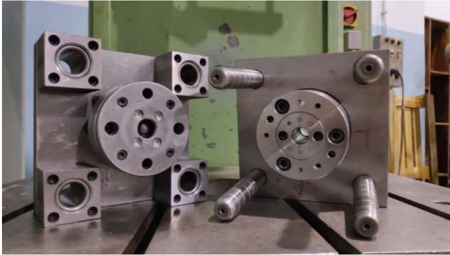
Şekil 3. Deneyler için üretilen kalıp
