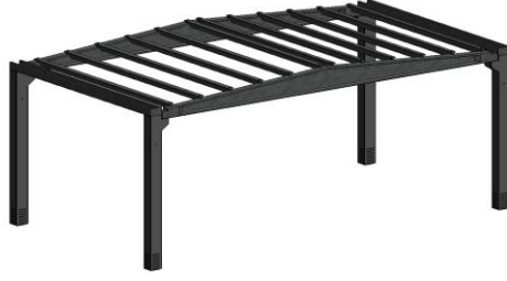
Şekil 1. Oluşturulan tek açıklıklı örnek prefabrik üstyapı tasarımı
