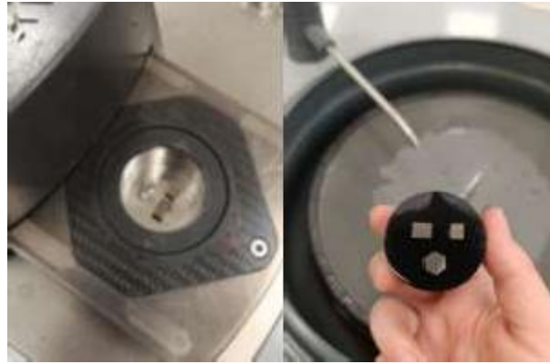
Şekil 4. Bakalite alınıp diğer işlemlere hazırlık süreci
