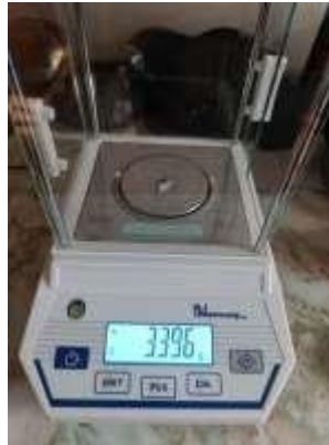
Şekil 6. Numunelerin aşınmasındaki ağırlık kayıplarını ölçmek için hassas terazi
