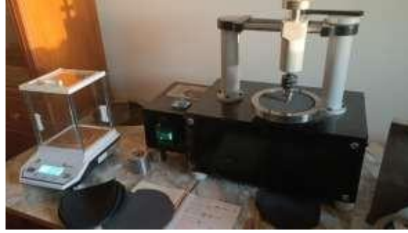
Şekil 8. Aşınma testinin uygulanması sırasında numune ve zımpara etkileşimi
