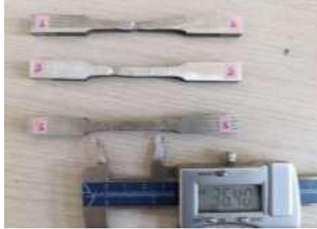
Şekil 8. Çekme testi sonrası kopmuş numunelerin görünümü
