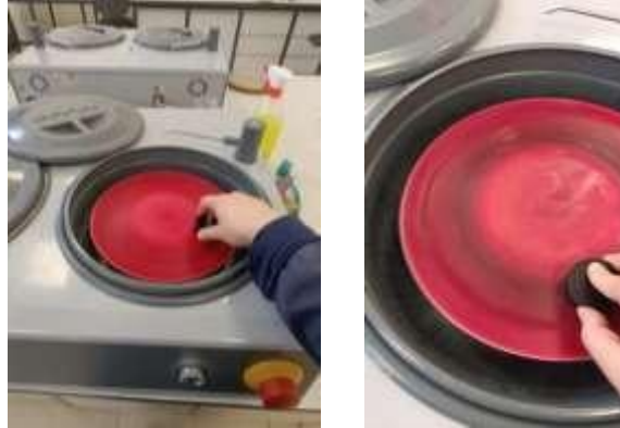
Şekil 5. Mikroyapı numunesinin ön parlatma aşaması
