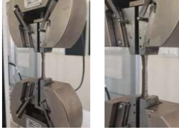
Şekil 7. Çekme testi sırasında numunenin boyun verme davranışı
