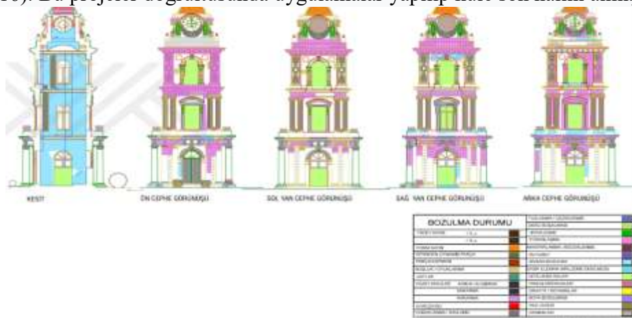
RESTORASYON ÖNCESİ CEPHE BOZULMALARI (Gürsu,2016).
