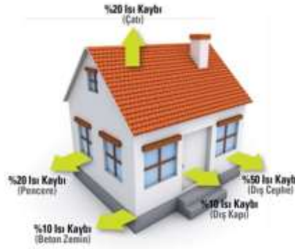
Şekil 5: Bina Cephelerindeki Isı Kayıpları [13]
