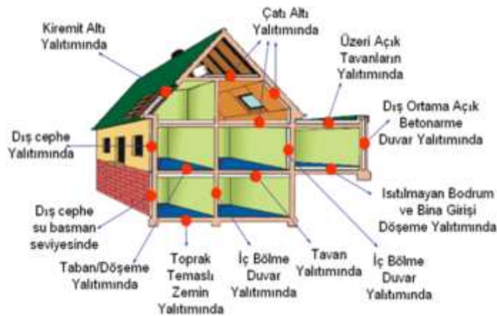
Şekil 12: Yapılarda ısı Yalıtımı Yapılabilecek yerler [20]
