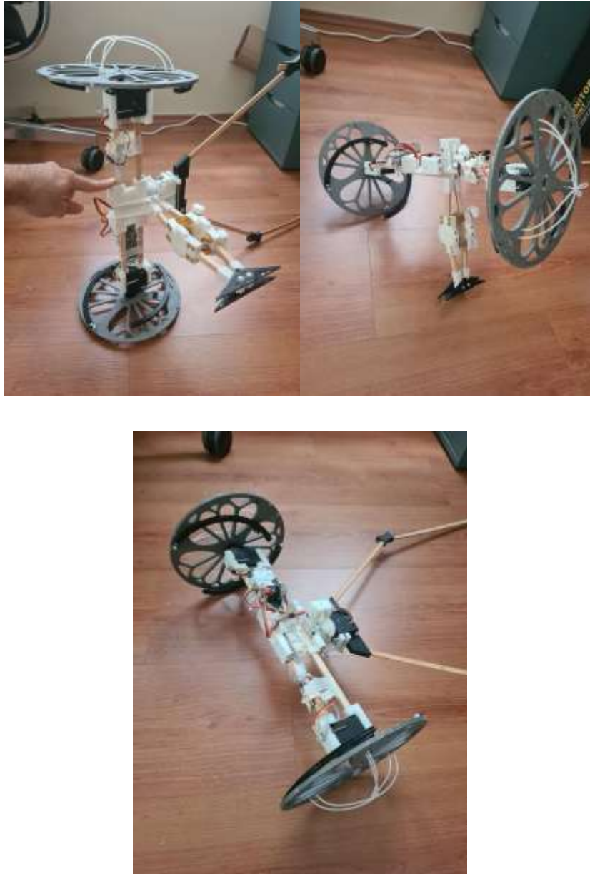
Şekil 2.6 Pasif kendini düzeltme sisteminin çalışma aşamaları
